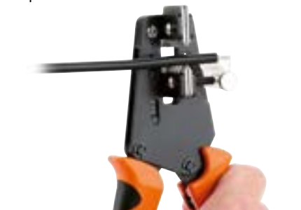
Kabel am Längenanschlag anlegen
