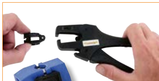
Leicht auswechselbare Messerkassetten
