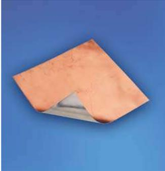
Elektro Cupal Tafeln bestehen aus Kupfer plattierten Aluminiumblechen. Da die Verbindungsstelle der beiden Metalle in das Innere der Bleche verlegt wurde, wird so ein Zutritt von Luft und Feuchtigkeit unmöglich. Mit diesem Material ist eine kontaktsichere und korrosionsgeschützte Verbindung von Kupfer und Aluminium möglich. Wir liefern zusätzlich zu den Cupal Tafeln und U-Scheiben auch Zuschnitte mit und ohne Bohrungen passend für Ihre Anwendungsfälle.
