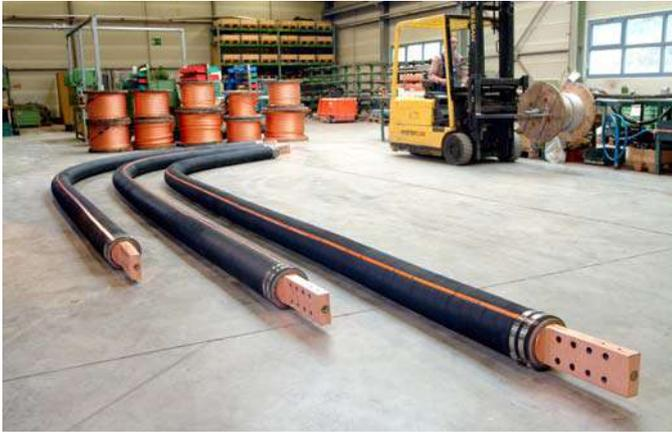
Standardkabel bis 6000 mm<sup>2</sup> Querschnitt
