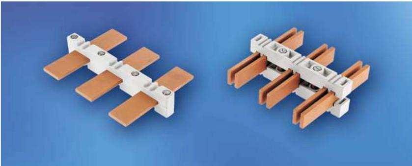
3-polige Sammelschienenträger aus glasfaserverstärktem Polyester, ähnlich DIN 16911 Typ 801. Geeignet zum vertikalen Klemmen von 5 und 10 mm starken Sammelschienen (Best.-Nr. 15636 + 15637) bzw. je Phase 2 Stück 10 mm starken Schienen vertikal oder 1 Stück Schiene 60 mm Breite horizontal (Best.-Nr. 15638). Die Schienenhöhe kann variabel durch entsprechende Abschnitte der Hartpapierhülsen gestaltet werden.
