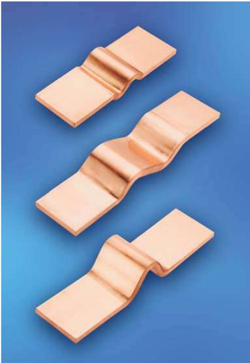
Die Fertigung der nachstehend aufgeführten Dehnungsbänder erfolgt aus Cu-HCP Folien (ehemaliges SE-Cu) entsprechend DIN EN 13599 in den Stärken 0,1 oder 0,3 mm. Die Anschlussenden sind in pressgeschweißter Ausführung ausgeführt. Das Pressschweißen ist ein spezielles Widerstandsschweißverfahren, welches es ermöglicht, ganze Flächen kompakt und ohne Verwendung von Schweißzusatzstoffen sicher zu verschweißen.
