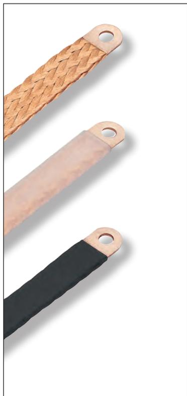
Als Standardisolation stehen nachträglich aufgezogene Silikon-schläuche oder Schrumpfschläuche zur Verfügung. Insbesondere die Silikon-schlauch isolierte Ausführung bietet eine sehr gute Flexibilität und einen großen Temperatureinsatzbereich von - 50 °C bis + 180 °C an.
