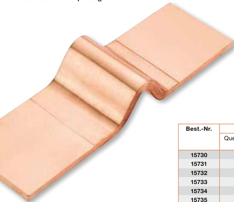
Dehnungsbänder in Standardausführung. Die Breiten und Stärken der Anschlüsse sind abgestimmt auf die handelsüblichen Stromschienenabmessungen. Auf Wunsch auch mit Bohrungen z. B. nach DIN 43673 Blatt 1 + 2, DIN 46206 Blatt 2 oder nach Angabe/Zeichnung bzw. mit verzinnnten oder versilberten Anschlussflächen oder komplett verzinkt oder versilbert lieferbar. Andere Abmessungen sowie andere Querschnitte oder Biegeformen auf Anfrage.
