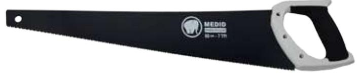
Sägeblatt hergestellt aus Magnesiumstahl | Ergonomischer zweifarbiger Griff aus ABS- + TPR-Kunststoff | Die Neigung der Zähne verleiht dem Blatt Härte und Widerstandsfähigkeit | Blattstärke: 1 mm (Ref. 877 ist 1,2 mm)
