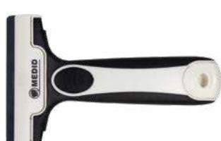
(ES) Rascador con mango bimaterial, ergonómico y antideslizante. Para cuchillas anchas (100 mm). El mango contiene 2 hojas de recambio en el interior. Incluye cuchilla negra de alta calidad en acero SKH2 (Ref. 2408).
